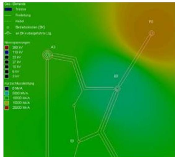
Bild 4: Grafische Visualisierung der Kurzschlussleistung
